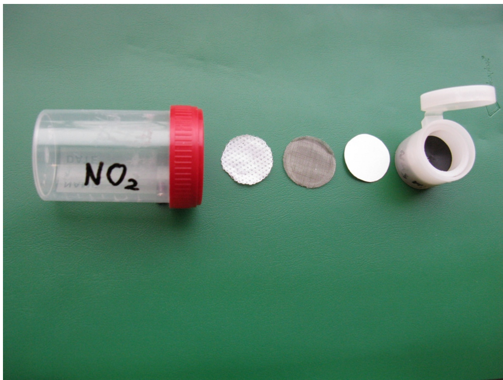
Joonis 6. Koguja ehitus. Vasakult paremale - tops, teflonmembraan, traatvõrk, keemiliste ühenditega immutatud filter ja ringikujulise avaga polüpropüleenist koguja korpus
