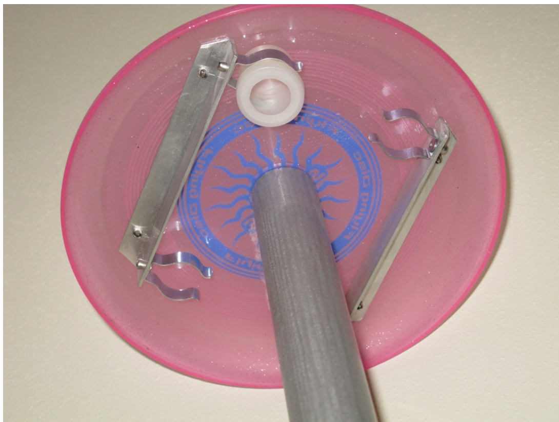
Joonis 8. Koguja kate ja puust vars.
