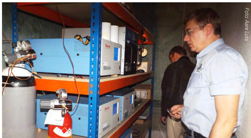
■ Gaasianalüsaatorid mõõtmis välisõhku Tahkuse õhuseirejaamas
