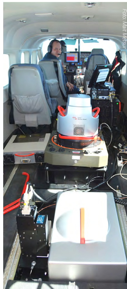
■ Spektromeeter (väike must kast eesplaanil) maa-ameti lennukis katsemõtmistel
