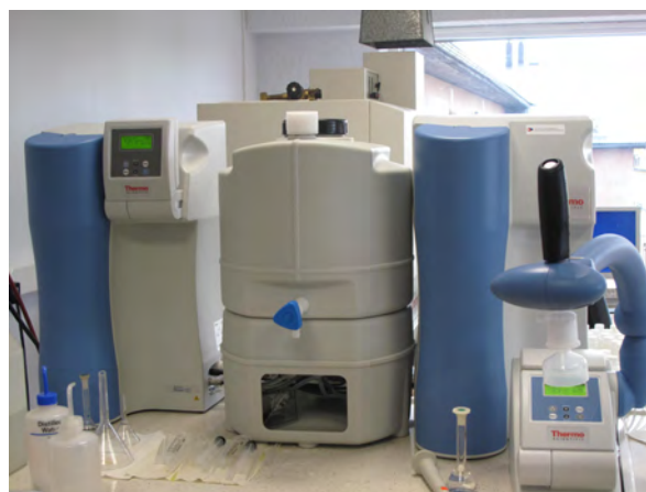
■ Аппарат по очистке воды
