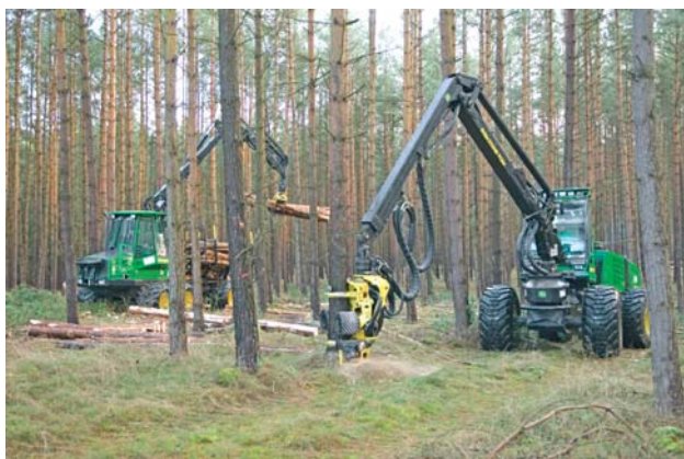
Harvester langetab puid, forvarder veab materjali metsast välja.
